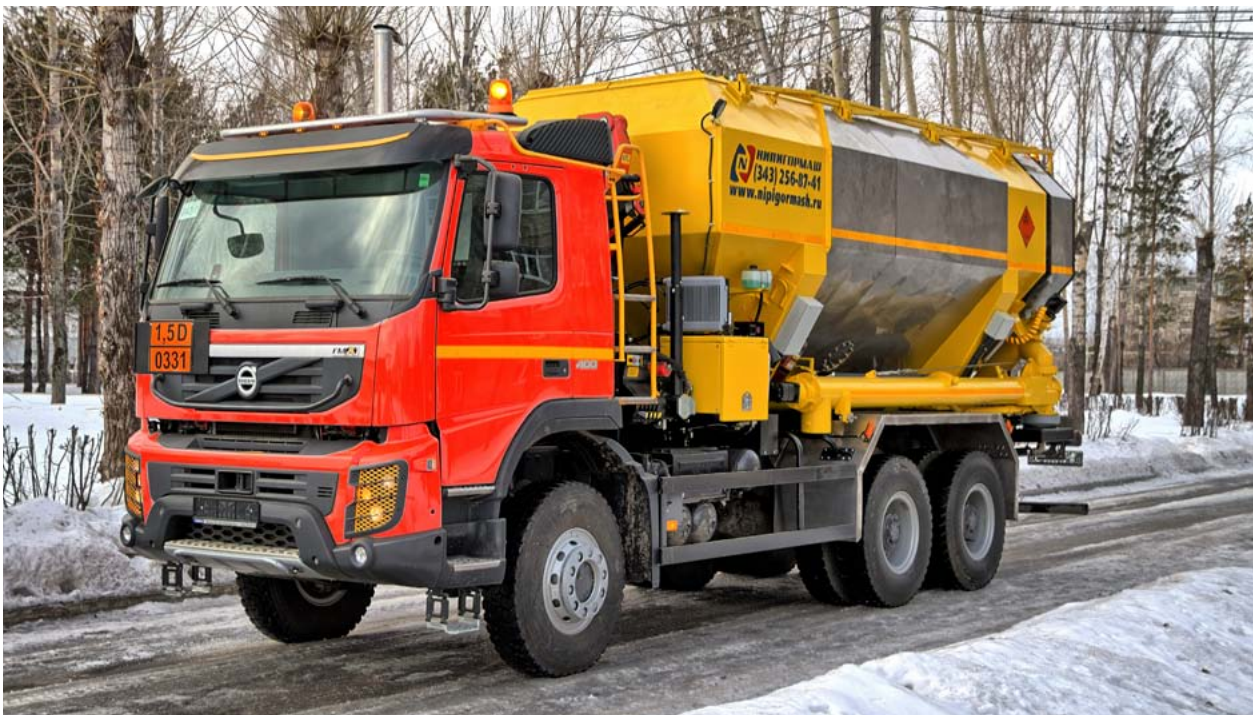
МСЗУ-15-НП-К на базе Volvo FM-Truck с колесной формулой 6х6
